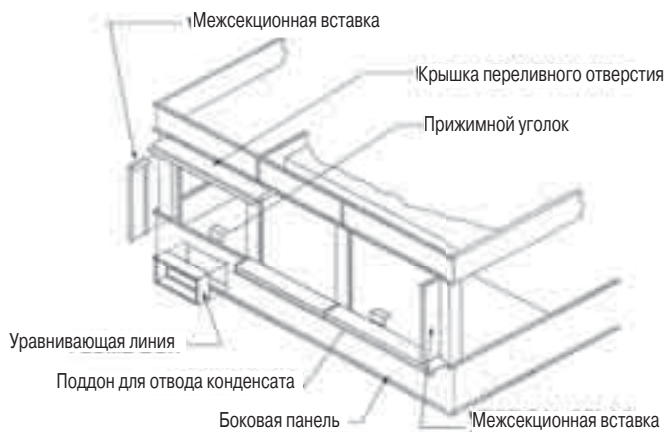
Рис. 8. Монтаж поддона для отвода конденсата и межсекционных вставок агрегатов шириной 4,9, 5,3 и 7,3 м
