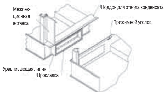
Рис. 3. Монтаж уравнивающей линии
