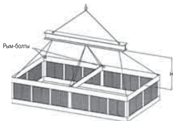
Рис. 2а. Секция водяного бака длиной до 6,3 м
