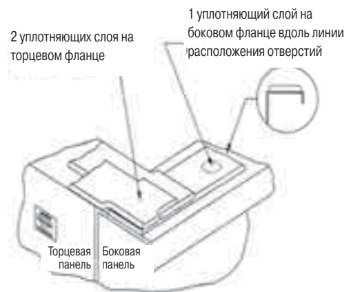
Рис. 9. Способ укладки уплотняющих слоев
